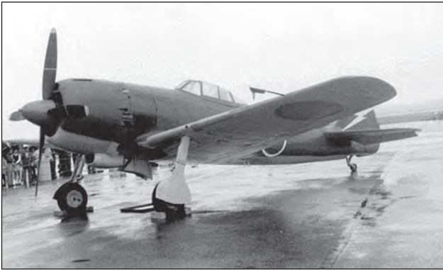
22. ábra. A Nakajima Ki-84 Hayate (Frank) a japán repülőgépgyártás egyik utolsó típusa. A két gépgyúval, két géppuskával, illetve 500 kg bombával felfegyverzett gépnek vadász és zuhanóbombázó változata is készült
