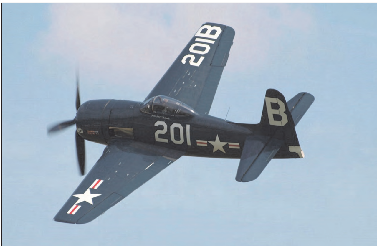
25. A Grumman F8F Bearcat vadászrepülőgép az F6F Hellcat továbbfejlesztéséből született, annál 20%-al könnyebb és 80 km/h-val gyorsabb volt, így egy a Hellcat-nél jobban manőverező és gyorsabb repülőgépet kaptak. Fegyverzetét négy 12,7 mm-es géppuska alkotta, motorja 2250 LE teljesítményű csillagmotor volt, emellett 1000 kg bombát is hordozhatott
